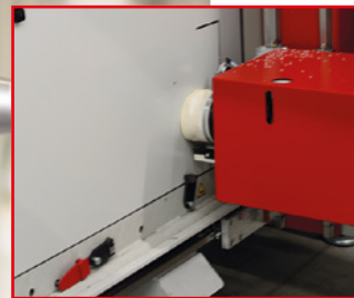
Millimetergenaue Fräsarbeiten: Hier entsteht gerade eine Aussparung für eine Lüfterabdeckung in einer Schalt-schränktür.
